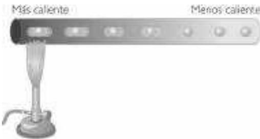
Figura 5. Conducción de calor en una barra metálica.
